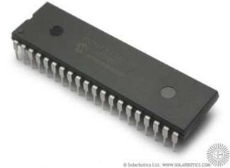
Nous avons dans notre cas entrepris de travailler avec un PIC18F4580 avec l'environnement de développement MPLAB et le compilateur MCC18, nous permettant de programmer en C directement sur le composant. L'avantage de ce genre de PIC est qu'il bénéficie d'une à plusieurs sorties PWM et d'un port série pour communiquer avec d'autres cartes électroniques.
